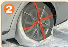
2 タイヤ(駆動輪)の接地部以外にかぶせ、車をタイヤ半回転移動させる。
