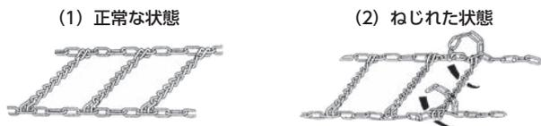
☆ねじれたまま装着走行しますと、早期折損、タイヤ損傷の原因となります。
