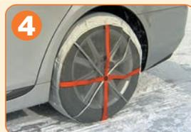
4 取付け完了。ゴム部がタイヤの内側に完全にかぶっていることを確認してください。(取付け完了時のタイヤ中心との多少のスレは、走行を始めるると中心に位置するよう自動的に補正されます。)
